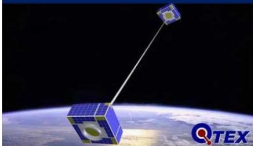
初期のJAXA導電性テザー実証実験用衛星のシステム設計や実験装置用制御装置の開発
